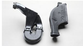
多孔气管，音质好 （左：入口，右：暖通空调）
